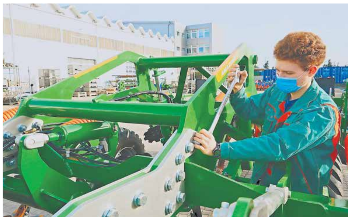
Christian Wagner, Industriemechaniker im ersten Lehrjahr, montiert Bauteile an einem Ceus 3000-TX. FOTO: BBG/TILO GRUENDEL
