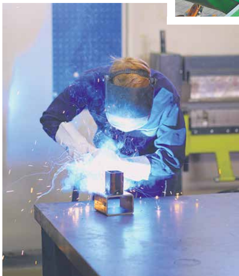
Fiete Wüstemann, Konstruktionsmechaniker im ersten Lehrjahr, trainiert das MAG-Schweißen an einem Übungsstück. FOTO: BBG/TILO GRUENDEL
